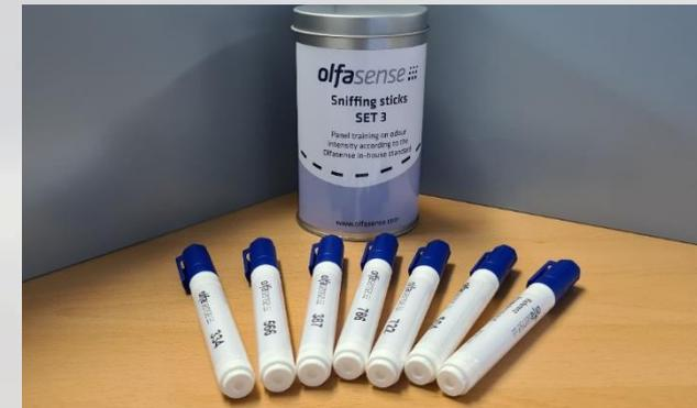
Mesure de l'intensité olfactive selon la norme NF X 43-103 par comparaison avec des étalons de butanol
